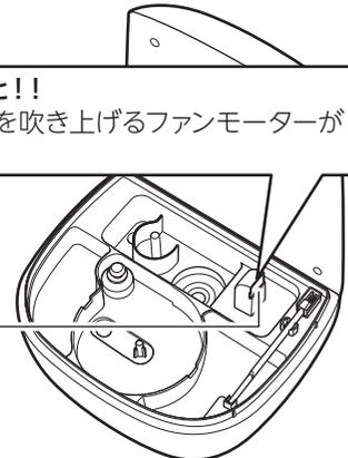
加湿運転時には中にあるファンモーターが回り送風口から風が出て、発生したミストを上へ吹き上げます。お手入れ時に水を入れないよう十分に注意してください。
