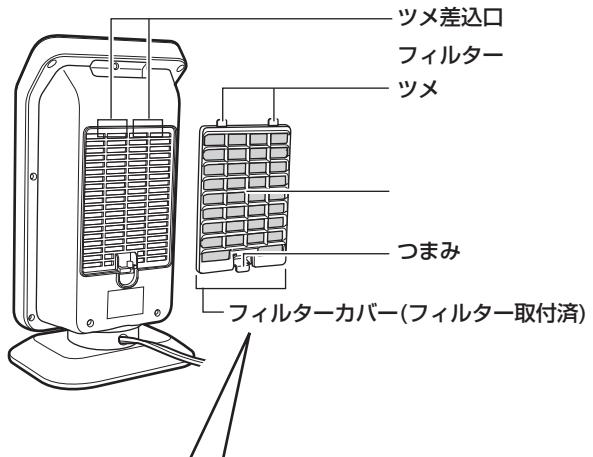
フィルターはお手入れのあと、フィルターカバー裏面にあるフィルター固定用ツメ(4か所)にフィルターを取り付けてください。
