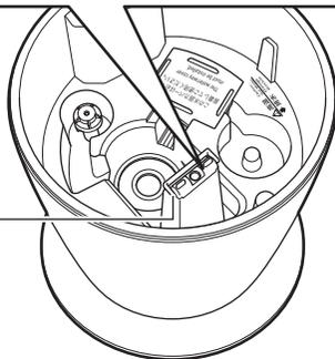
加湿運転時には中にあるファンモーターが回り、送風口から風が出て、発生したミストを上へ吹き上げます。お手入れ時に水を入れないよう十分に注意してください。
